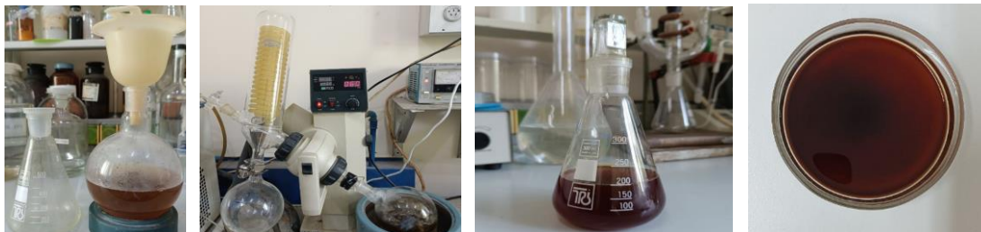
3-rasm. Rotorli bug'latish uskunasi yordamida olingan ekstragentni quyiltirish jarayoni
