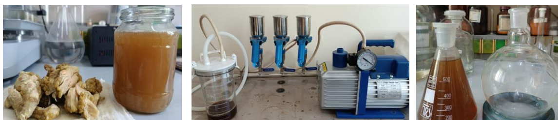
2-rasm. Spirtli ekstragentni tozalash va filtrlash jarayonlari.
