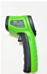
Este termômetro infravermelho é usado para medir a temperatura sem contato com segurança e rapidez.
