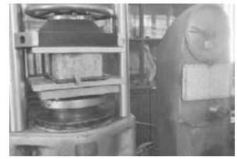
Hình 9. Xác định KLTT và cường độ chịu nén của gạch đất không nung
