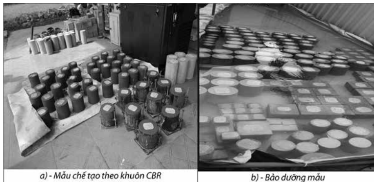
Hình 2. Chế tạo mẫu vật liệu gia cố làm lớp móng mặt đường
