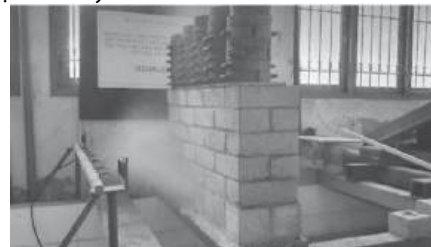
Hình 11. Thử nghiệm độ bền chịu nước của khối xây (ở trạng thái đang chịu tải)
