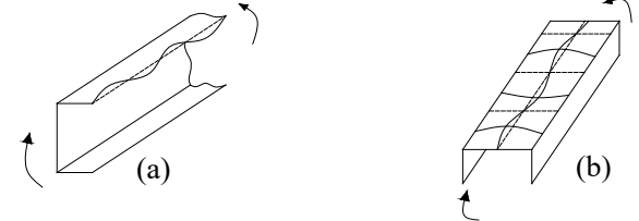
Hình 1. Mất ổn định cục bộ tiết diện chịu nén (a) Cánh chịu nén, (b) Bụng bụng chịu nén [3]
