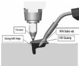
Hình 1. Quy trình hàn hồ quang laser lai
