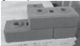
Hình 8. 02 mẫu gạch đất không nung được nghiên cứu chế tạo thử nghiệm
