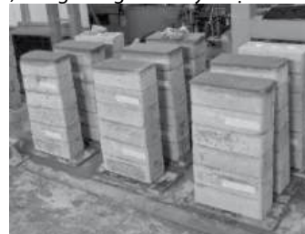
Hình 12. Thí nghiệm khả năng chịu nén của khối xây [7]
