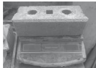
Hình 9. Xác định KLTT và cường độ chịu nén của gạch đất không nung
