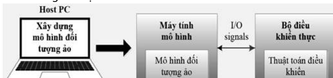
Hình 2. Cấu trúc hệ thống mô phỏng HIL
