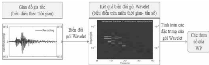
Hình 1. Sơ đồ Xác định liên hệ giữa giản đồ gia tốc và các đặc trưng của gói Wavelet (Wavelet Packet- WP)
