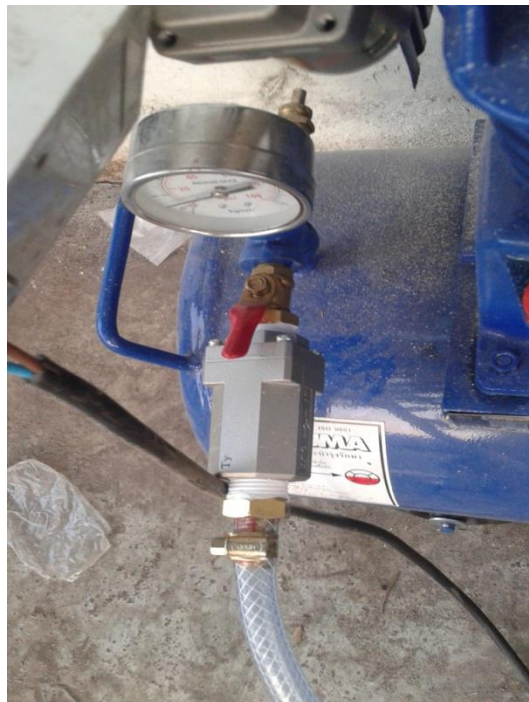
รูปที่ ๒.๙ การติดตั้ง Check valve ที่ขาออกของปั๊มอัดก๊าซชีวภาพ
