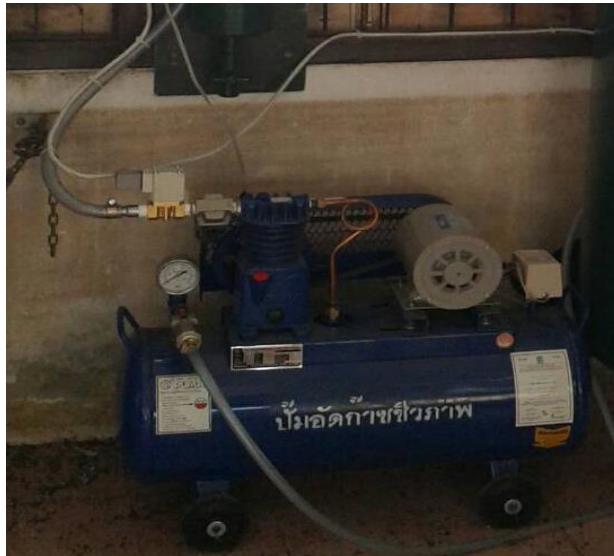
รูปที่ ๒.๘ การเชื่อมสายถักเข้ากับวาล์วไฟฟ้าบนปั๊มอัดก๊าซชีวภาพ
