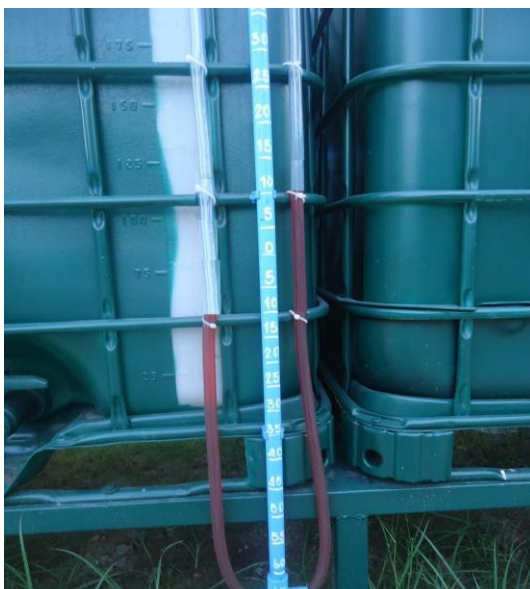
รูปที่ ๒.๒๒ บารอมิเตอร์น้ำขณะมีก๊าซชีวภาพในระบบ
