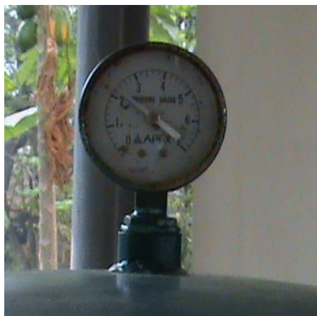
รูปที่ ๒.๒๓ แรงดันก๊าซชีวภาพแสดงที่หัววัดแรงดันประมาณ ๒.๒ บาร์
